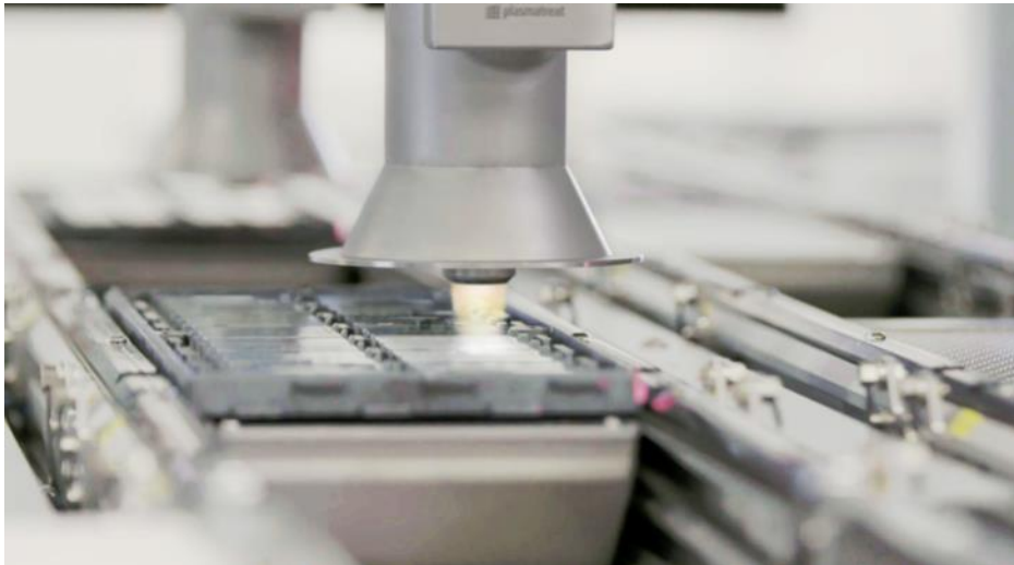
Plasmaoberflächenbehandlung von Bauteilen im Dual-lane-concept bei der Halbleiterherstellung.
